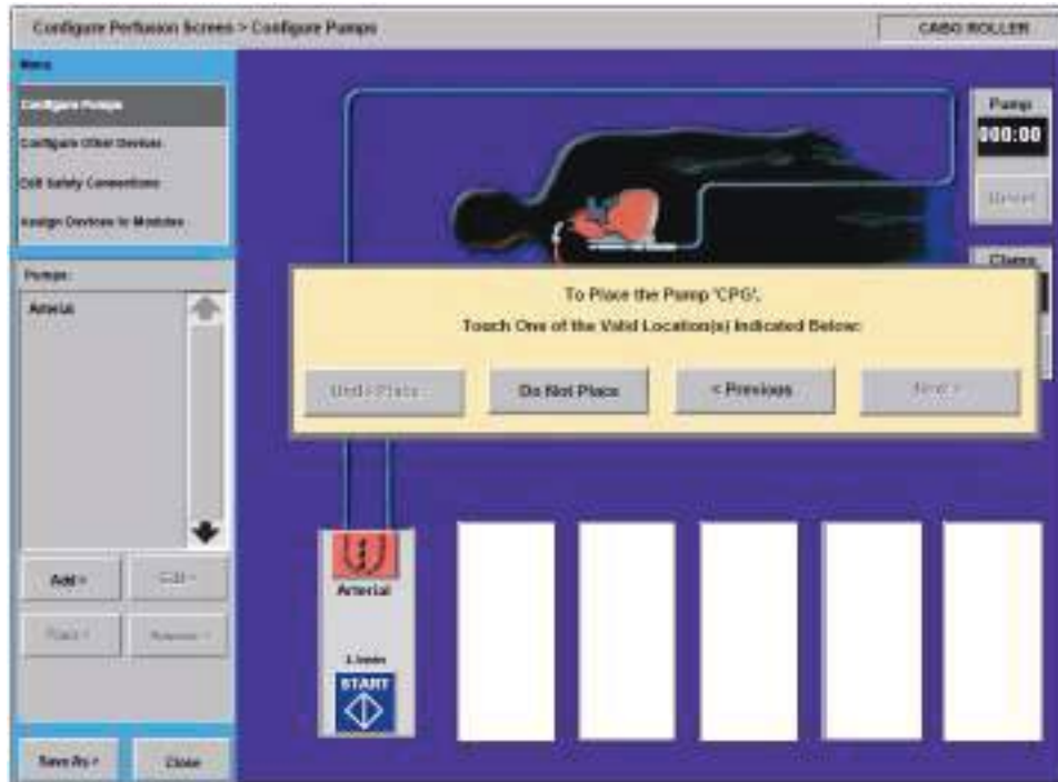
㉠. Add, Edit, Place 및 Remove 버튼을 활용하여 펌프 배치와 구성을 변경 가능하다.
